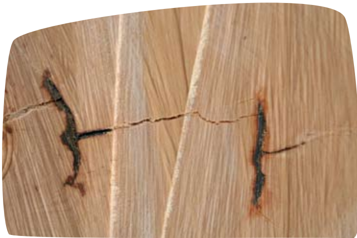
Radiale scheuren starten vaak bij overgroeïde wonden.
